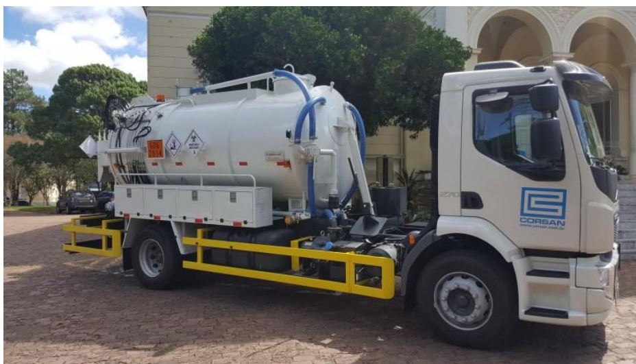
Figura 08: Equipamento para limpeza (remoção) do lodo de fossas sépticas/filtros anaeróbicos.
